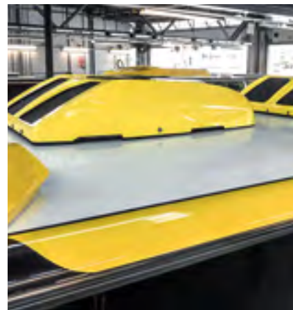
Die Modulklimaanlage Citysphere sorgt für angenehme Temperaturen wie hier in Utrecht, Niederlande
