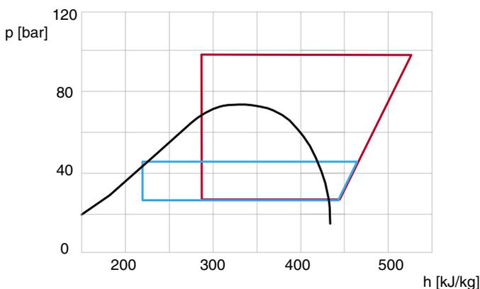
Abb. 3: Beispiele Sommer- ( — ) und Winterbetrieb ( — ) im p,h-Diagramm
