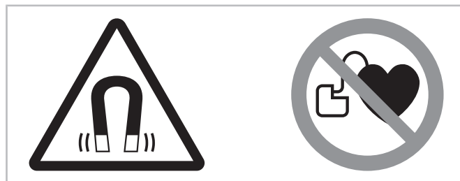
Fig. 1: Plaques d'avertissement et d'interdiction apposées sur le compresseur
